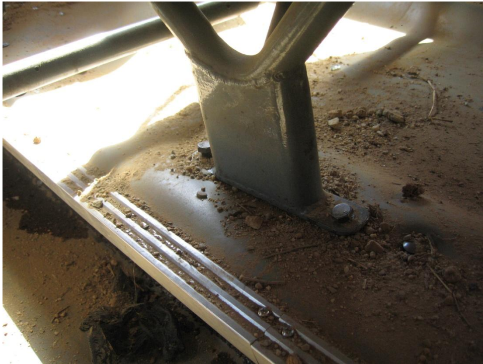
รูปที่ 3-7 การยึดติดเบาะที่นั่งกับพื้นรถ
