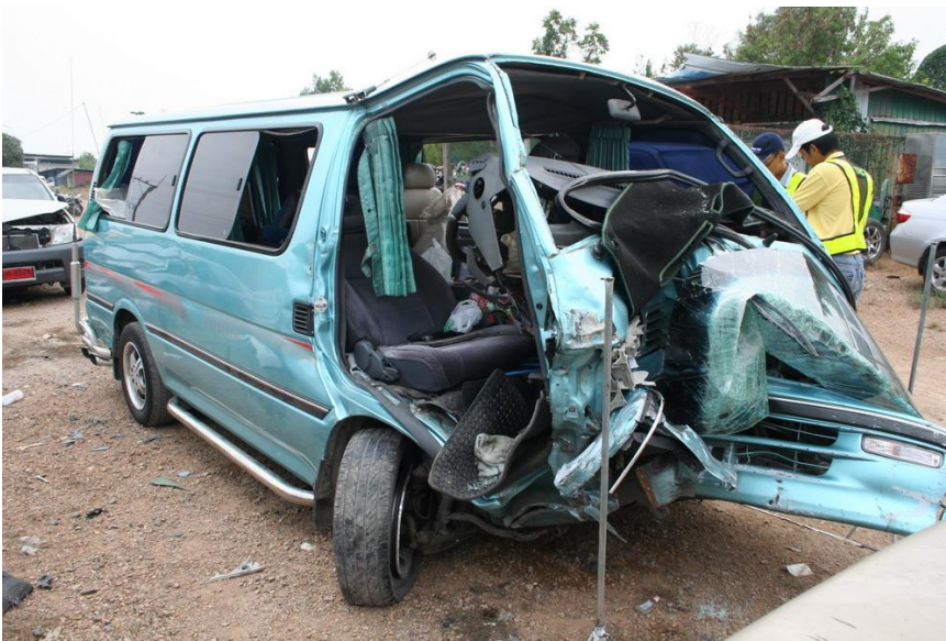
รูปที่ 3-4 รอยยุบตัวที่บริเวณตอนหน้าของรถตู้
