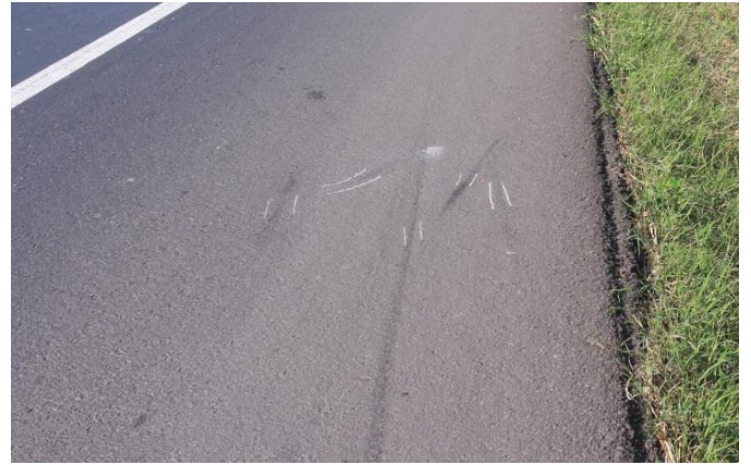
รูปที่ 24 หลักฐานในที่เกิดเหตุ แสดงตำแหน่งที่เกิดการชน (POI)
