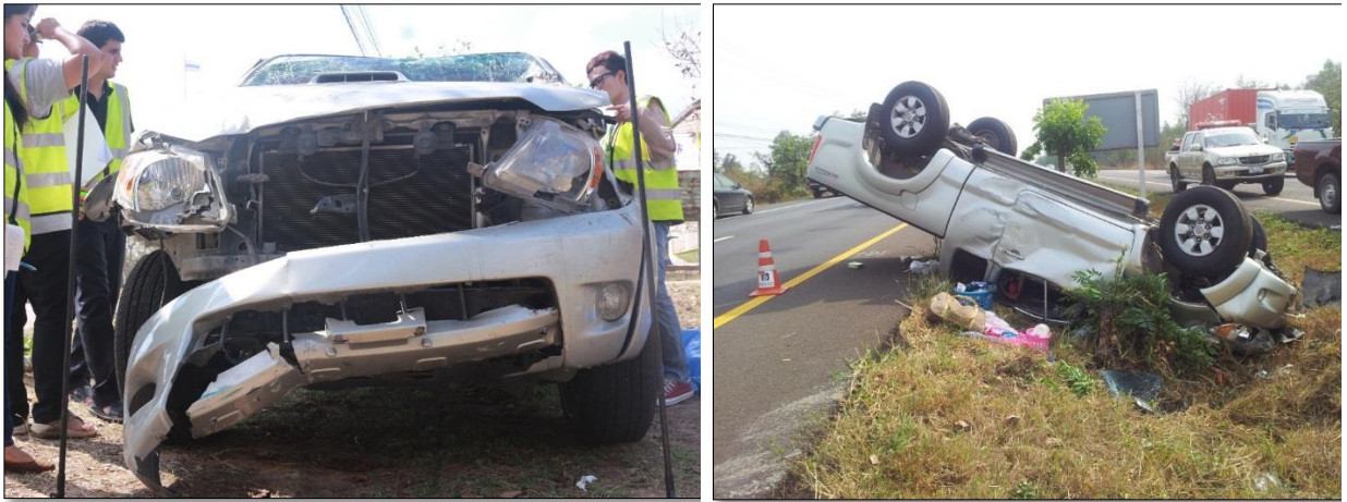
รูปที่ 11 ความเสียหายด้านหน้าของรถกระบะ (V1)
