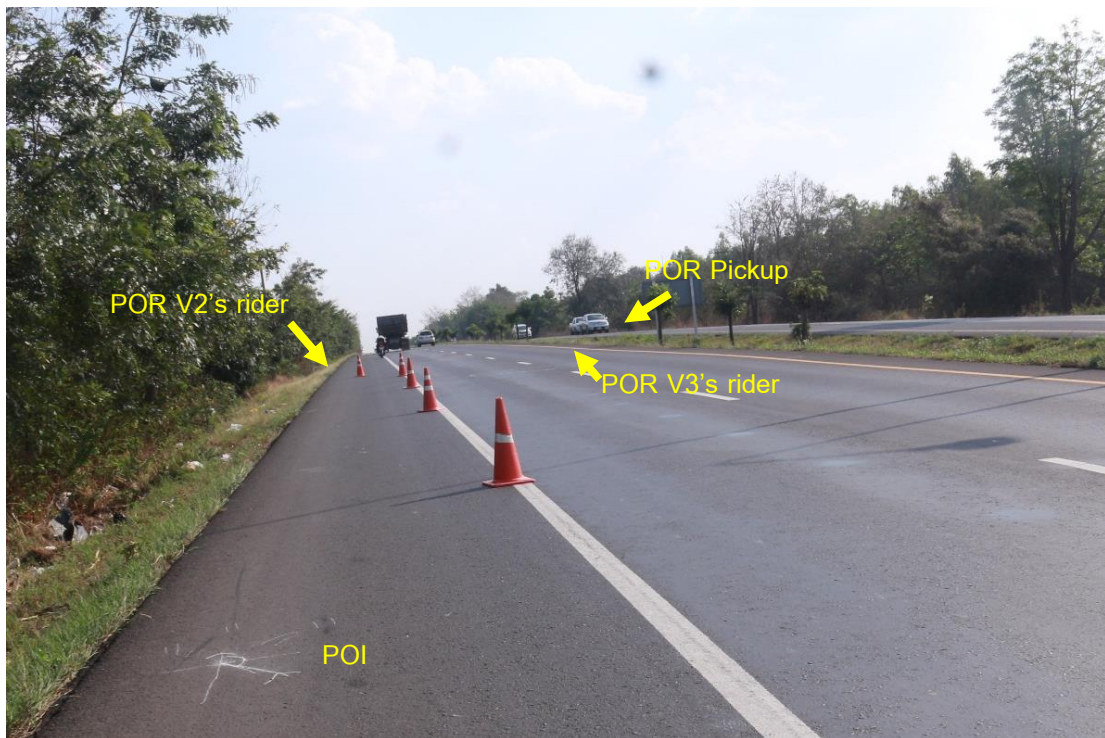
รูปที่ 29 ตำแหน่งที่เกิดการชน และตำแหน่งสุดท้ายของรถกระบะและคนขี่จักรยาน
