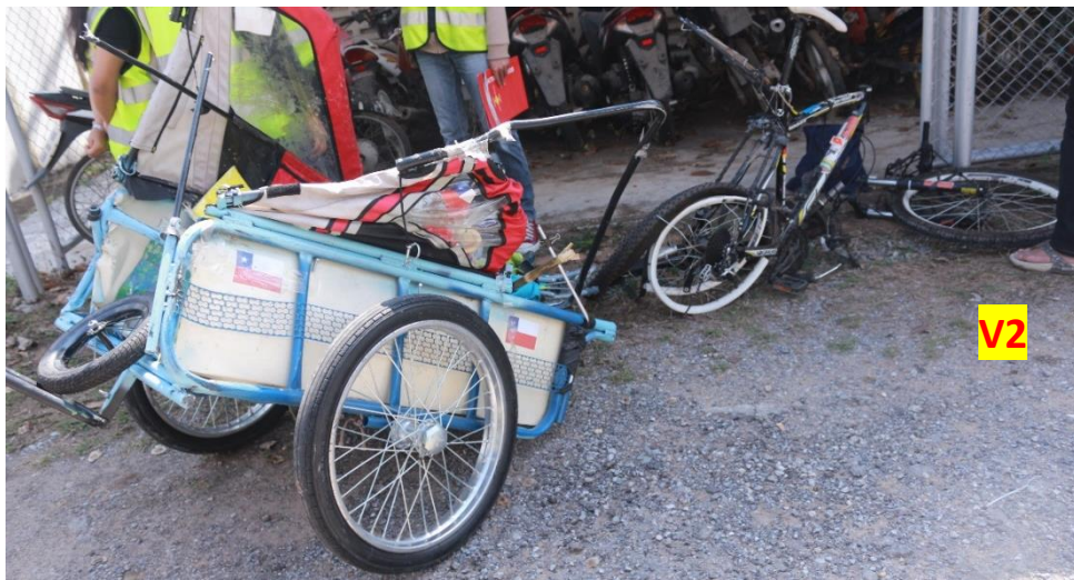
รูปที่ 16 ความเสียหายของตัวพ่วงที่พ่วงมากับจักรยาน V2
