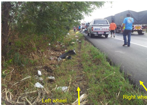
รูปที่ 25 รอยล้อรถกระบะ (ความยาว 25 เมตร) บริเวณพื้นที่ลาดชันข้างทาง
