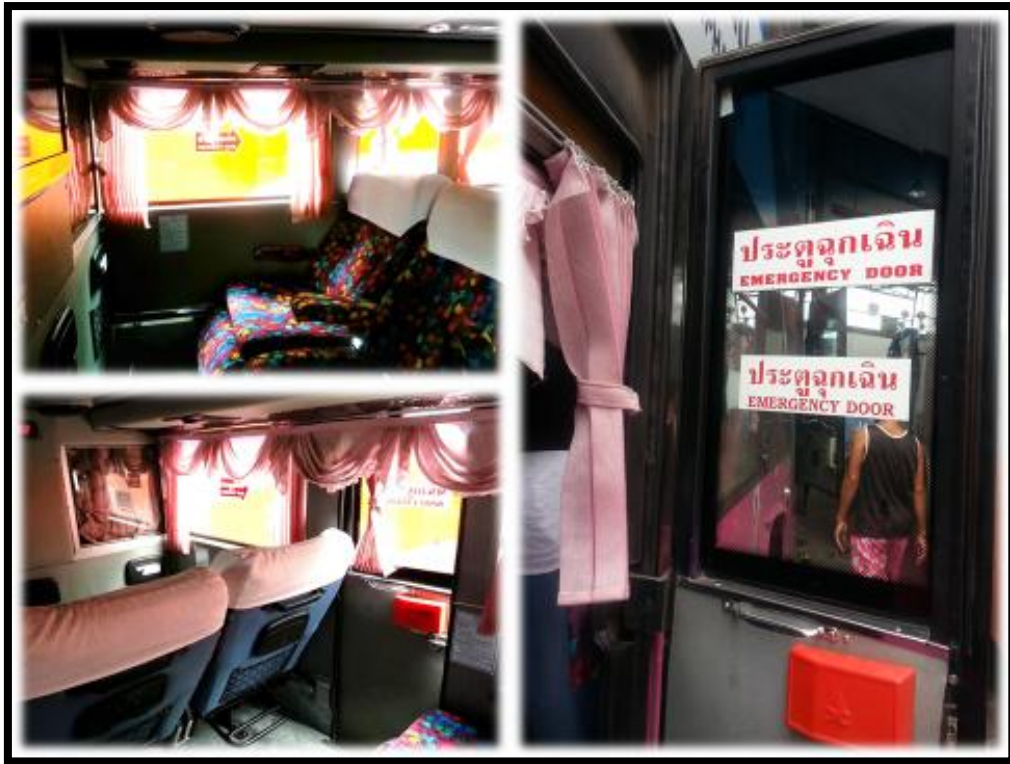
รูปที่ 8 กระจกฉุกเฉิน และ ประตูฉุกเฉิน ภายในตัวรถ
