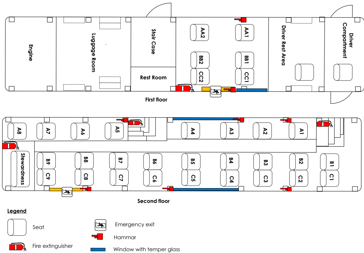
รูปที่ 6 ตำแหน่งที่นั่ง และอุปกรณ์นิรภัยต่างๆ ภายในรถ
