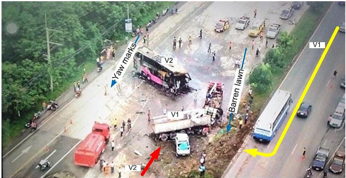
รูปที่ 16 คั่นดิน และ รอยเบรคหลังจากเกิดเหตุ
