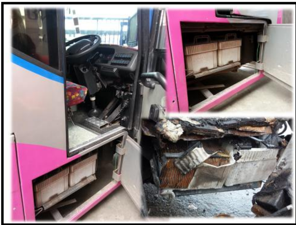
รูปที่ 14 ตำแหน่งของเบาะเดือรี่ ในสภาพปกติและหลังเกิดเหตุ
