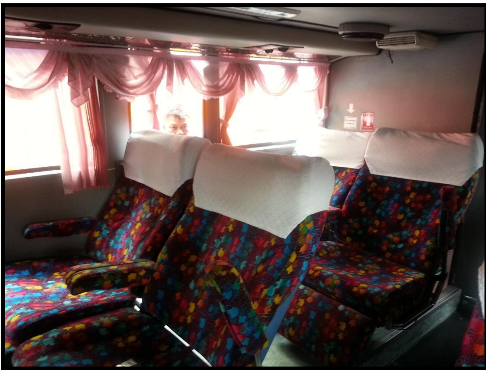
รูปที่ 22 วัสดุและอุปกรณ์ติดตั้งภายในรถที่เป็นเชื้อเพลิงอย่างดี
