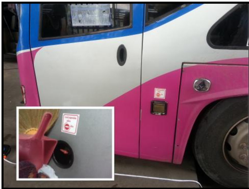
รูปที่ 7 ประตูหลักด้านหน้าซ้ายของรถ และวาล์วเปิดประตูฉุกเฉิน
