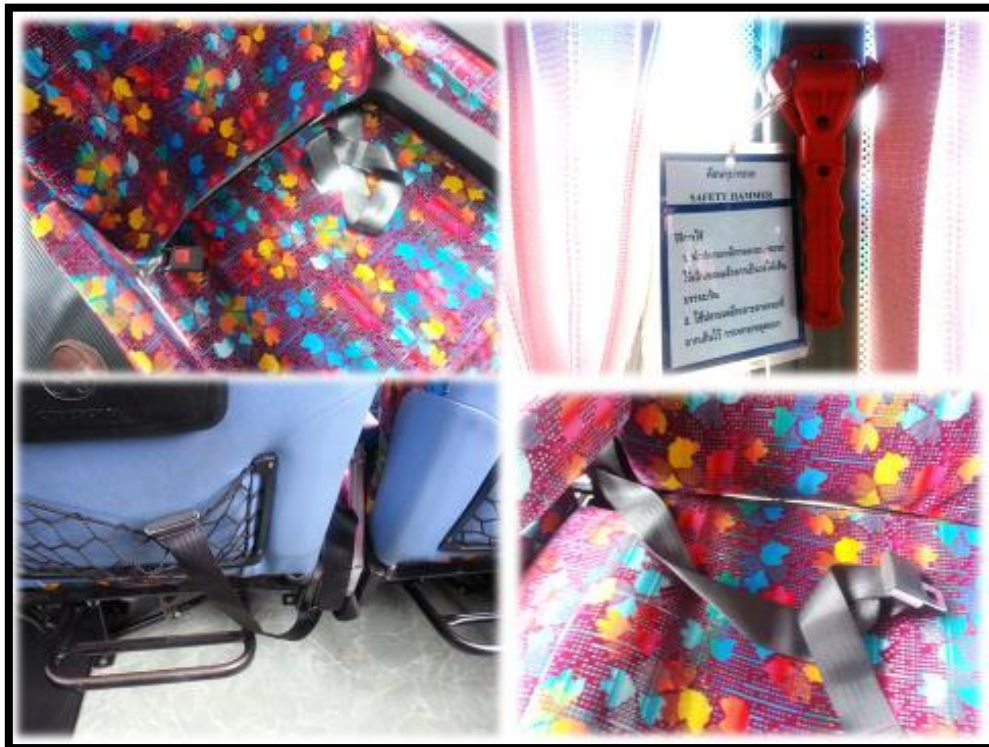
รูปที่ 9 เข็มขัดนิรภัย และ ค้อนนิรภัย ภายในตัวรถ
