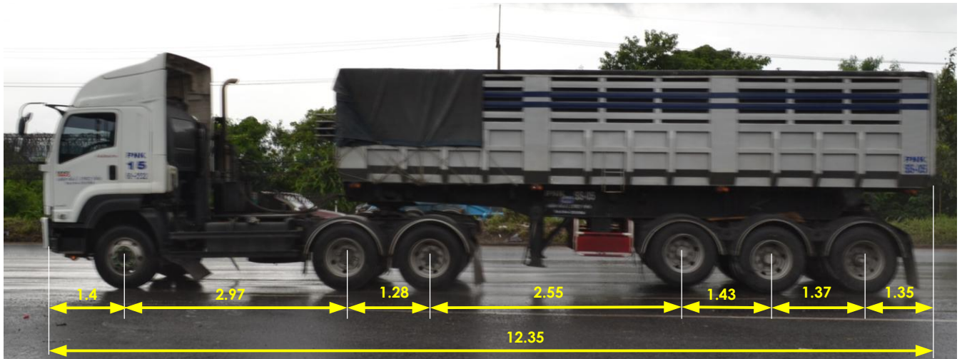
รูปที่ 3 ขนาดมิติของรถบรรทุก (V1)
